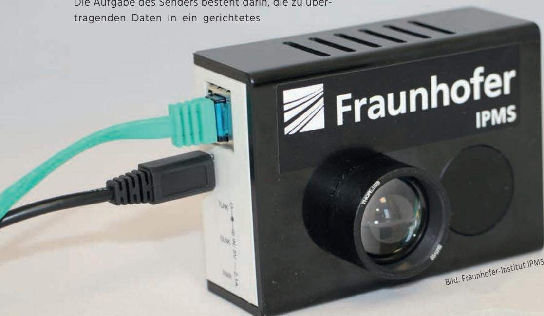
*Das Modul Li-Fi HotSpot des Fraunhofer IPMS dient zur optischen kabellosen Datenübertragung über große Distanzen.*
