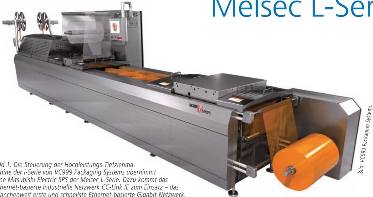
Bild 1: Die Steuerung der Hochleistungs-Tiefziehmaschine der i-Serie von VC999 Packaging Systems übernimmt eine Mitsubishi Electric SPS der Melsec L-Serie. Dazu kommt das Ethernet-basierte industrielle Netzwerk CC-Link IE zum Einsatz – das branchenweit erste und schnellste Ethernet-basierte Gigabit-Netzwerk.
