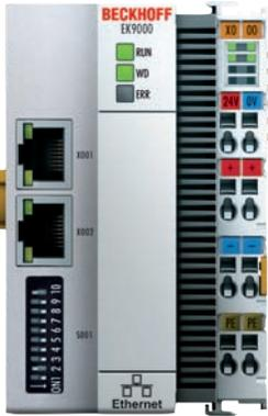
Der Buskoppler EK9000 verbindet Ethernet-Netzwerke mit den EtherCAT-Klemmen (ELxxxx) sowie Ethercat-Box-Modulen (EPxxxx) und setzt die Telegramme von Ethernet auf die E-Bus-Signaldarstellung um. Eine Station besteht aus einem EK9000 und einer beliebigen Anzahl von Ethercat-Klemmen. Der Anschluss an Ethernet erfolgt über RJ45. Mit Ethercat verfügt der Ethernet-Koppler über ein unterlagertes, leistungsfähiges und schnelles I/O-System mit einer großen Klemmenauswahl.
