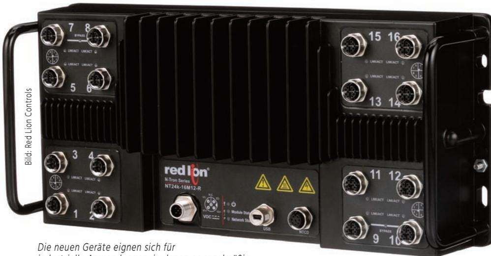
**Immer mehr industrielle Geräte nutzen Power over Ethernet – kurz PoE. Auch die neuen Switch-Modelle von Red Lion sind darauf ausgelegt. Zudem bieten die Geräte Bypass-Relais und volle Gigabit-Leistung.**
