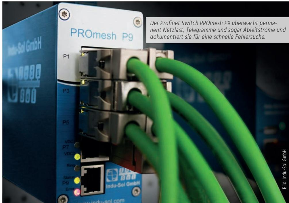
Der Profinet Switch PROmesh P9 überwacht permanent Netzlast, Telegramme und sogar Ableitströme und dokumentiert sie für eine schnelle Fehlersuche.
