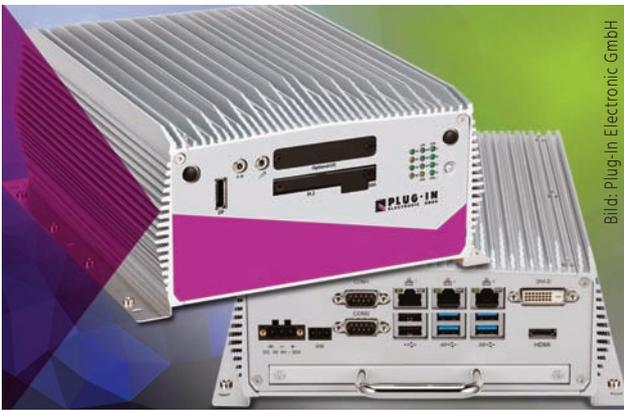
Die lüfterlosen Computer von Plug-In Electronic sind mit bis zu vier USB3.0-Ports und drei GbE-LAN-Ports ausgestattet.
